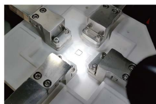
水凝胶材料双轴拉伸测试
