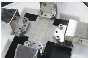
柔性电子双轴拉伸测试
