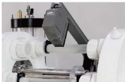
深度集成激光测径系统
